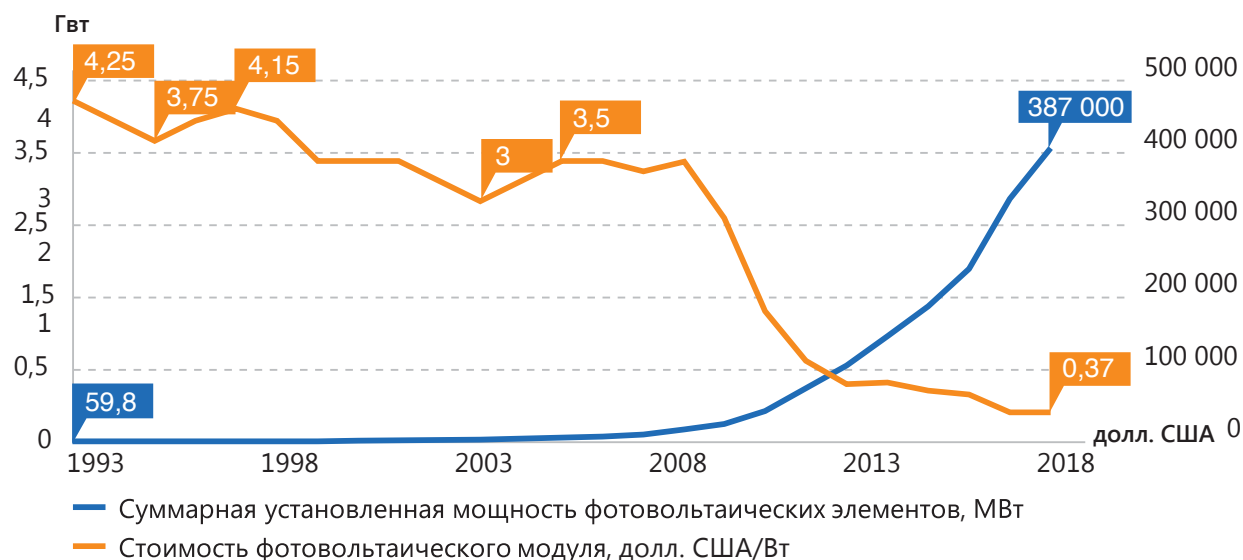
Рисунок 4. Скорость развития технологий фотовольтаики: соотношение установленной мощности и стоимости модулей.
